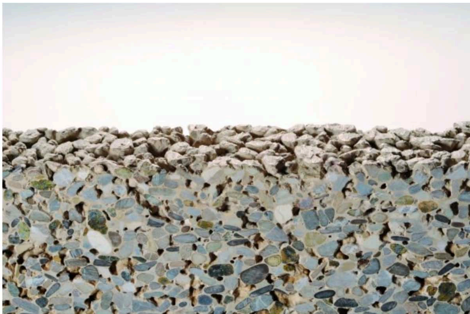
Drainbeton di Betonrossi è un calcestruzzo drenante e fonoassorbente dalle prestazioni eccezionali, adatto per la realizzazione di piste ciclabili, strade e viali, percorsi per impianti sportivi...
